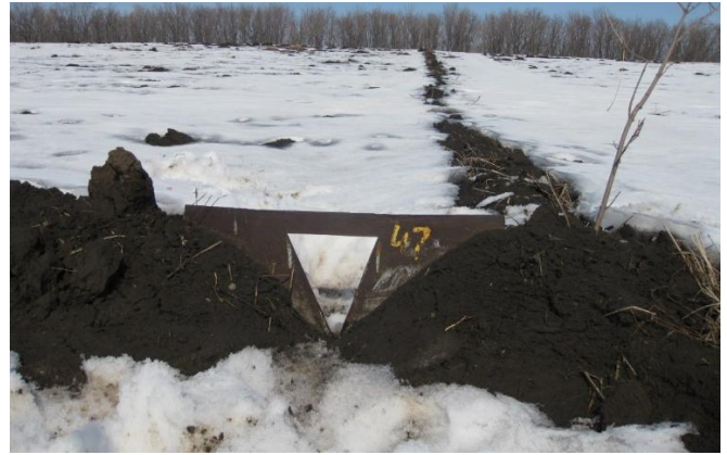
Рисунок 8 - Стоковая площадка, оборудованная водосливом.
